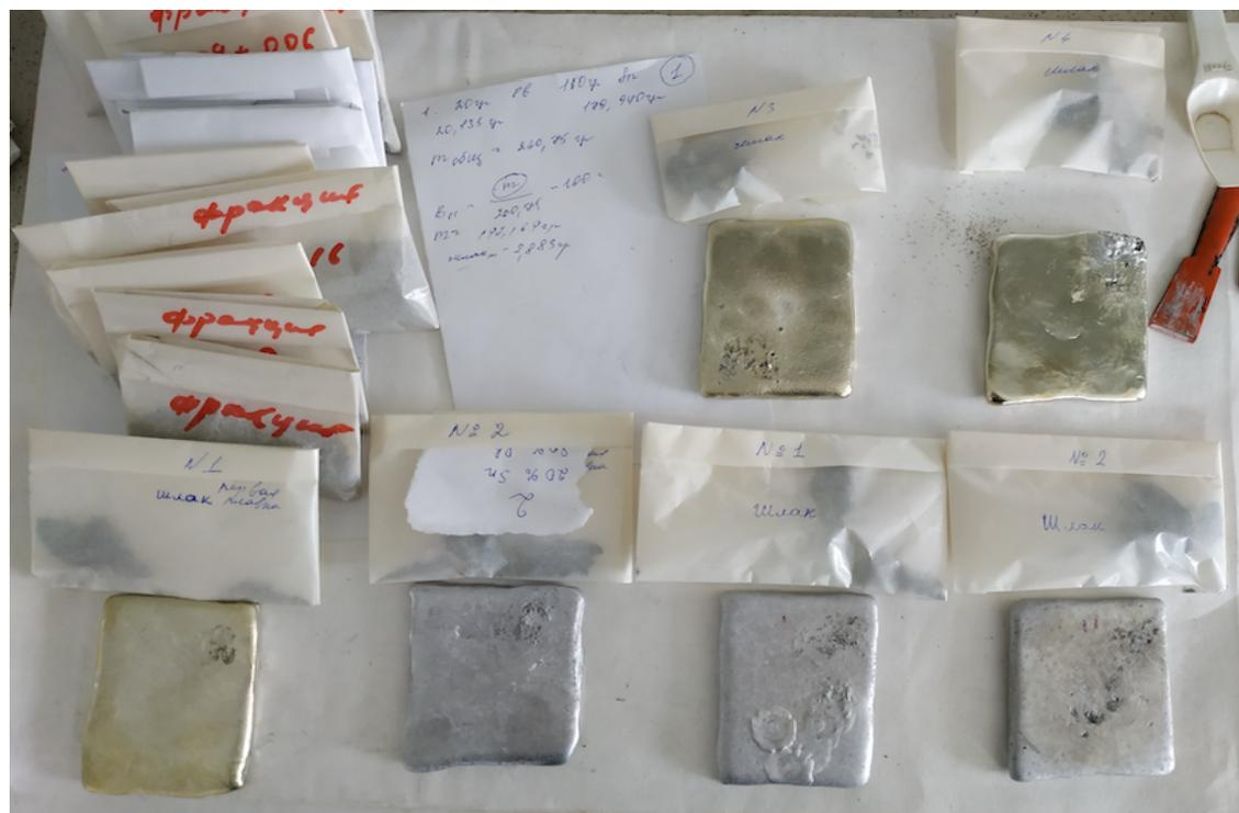
Рисунок 2.1 – Внешний вид модельных свинцово-оловянных сплавов, полученных путем сплавления чистых металлов
